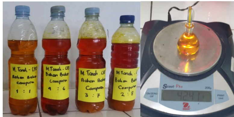
(a) (b) Gambar 3.2 a. Sampel Bahan bakar campuran dari berbagai variasi b. Penentuan Densitas menggunakan Piknometer 25 ml
